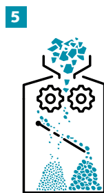
Aufbereitung von Betonabbruch im EBIREC
